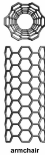
Figura 2.6 – Estrutura geométrica do nanotubo de carbono de parede simples do tipo armchair.
